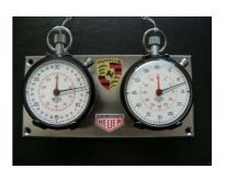
Son los aparatos de medición adicionales que podemos montar en el vehículo y que nos sirven para ajustar la medición de nuestro coche con la expresada en el Rutómetro. Los hay de distintos tipos y precios, dependiendo de las características de cada uno.
