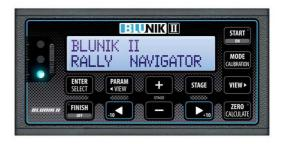
Tiene también teclas para subir o bajar metros, hacer un freeze (congelar la pantalla para ver la distancia exacta en una viñeta), arranque automático o manual. Comprobación de fallos en sondas,...
